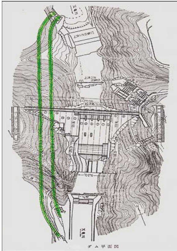
図 2-3 佐久間ダムの仮排水路
