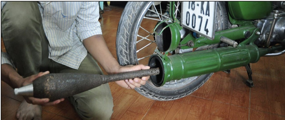
図 3-9 爆弾から転用された排気ガス装置の中に入れる部品（当時のもの）
